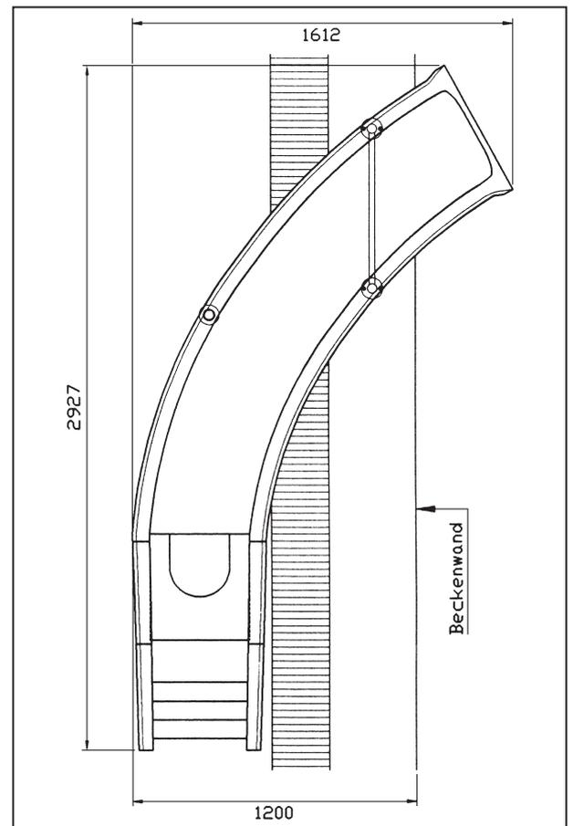
**Bogenrutsche „Kompakt“** aus GfK, rot oder blau für schmale Beckenumgänge, schwungvoll nach rechts ca. 30° abgebogen, mit sicherer tiefer Rutschmulde und sicherem Aufstieg mit Edelstahlgeleänder.
