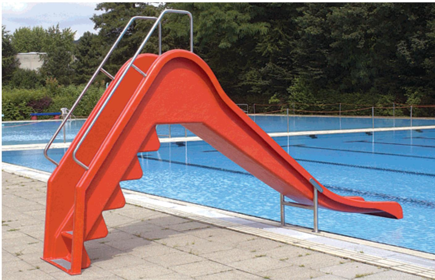
**Rutschbahn Nr. R 152/1,2 N** aus glasfaserverstärktem Kunststoff (GfK), Farbe weiß oder rot RAL 2002 (oder Sonderfarben). Geländer und Beckenrandabstützung aus V4A-Edelstahl. Plattformhöhe 1,10 m, Länge der neugestalteten Rutschmulde 2,50 m, Gesamtlänge 3,60 m.
